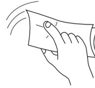
2. Décoller le dos de l'adhésif de la plaque magnétique et l'appliquer à l'endroit désiré. Attendez 24 heures pour que la colle se solidifie avant de placer le luminaire.
